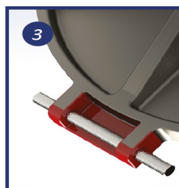
Болтовое шарнирное крепление крышки
